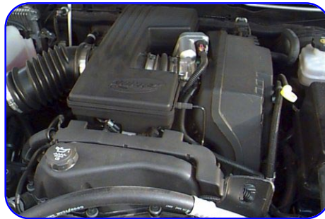
Vortec 3500 Inline 5 Cyl. engine
